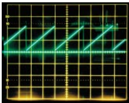
Bild 22b: Sägezahnspannung, ins Positive verschoben. x = 0,2 ms/skt, y = 2 V/skt.
