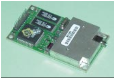
Bild 4: Eine zweiseitige SMD-Bestückung ermöglicht eine geringe Baugröße.
