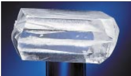
Bild 1: Galliumorthophosphat-Kristall Werkfoto: AVL List GmbH [4]
