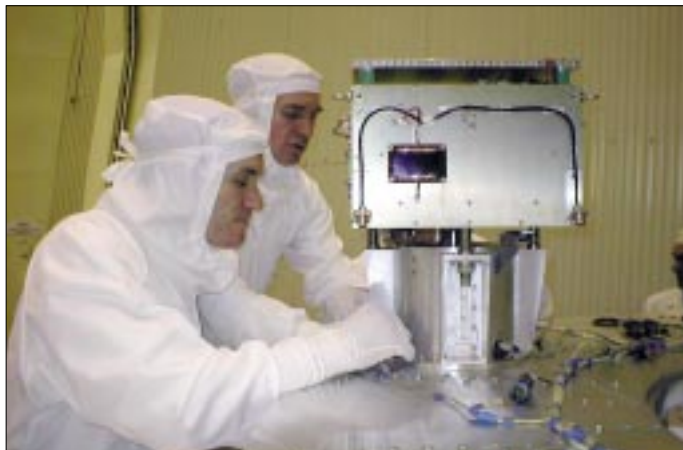
Der Satellit Rubin-2 bei der Montage auf der Separationseinheit. Vorn erkennt man die beiden N-Anschlüsse, auf die noch die Antennenstäbe geschraubt werden. Die Kabel führen zur AATiS-Amateurfunknutzlast SAFIR-M, die mittlerweile die internationale Bezeichnung AO-49 erhielt. Als Rufzeichen wird DPOAIS verwendet.
