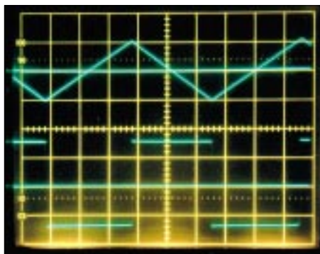
Bild 21: Die Ausgangsspannungen des Funktionsgenerators. Oben: U_d mit 2 V/skt. Unten: U_r mit 5 V/skt. Beide: x = 0,2 ms/skt; R = 33 k \Omega , C = 33 nF, R_1 = 100 k \Omega , R_m = 390 k \Omega
